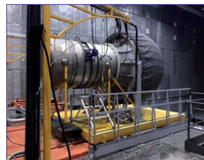
Двигатель Д-36 на стенде для проведения испытаний
