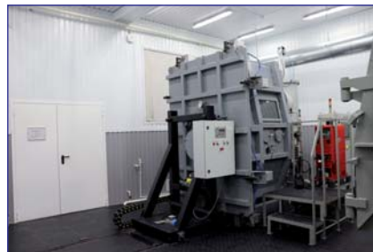
Установка электродуговой сварки в инертной среде
