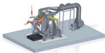
Создание мобильных винтомоторных стендов для испытания авиационных поршневых двигателей АПД-80 и АПД-200
