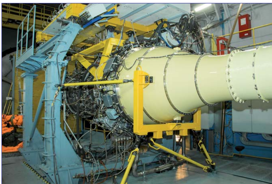
Газогенератор двигателя ПД-35 на испытательном стенде АО «ОДК-Авиадвигатель»
