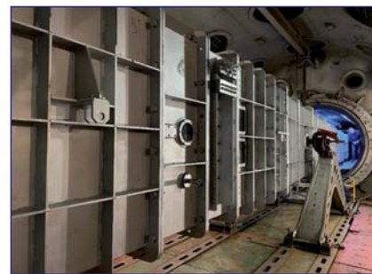
В 2022 году в ЦИАМ разработан стенд для сертификационных и инженерных испытаний авиатехники в условиях обледенения, соответствующих приложению «О» к CS-25 и FAR-25
