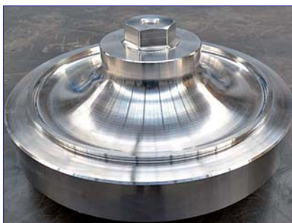
Диск-вал из гранул сложнолегированных жаропрочных никелевых сплавов
