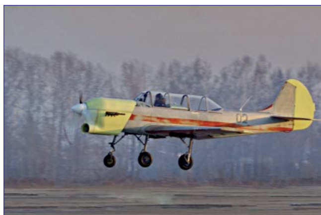
Летные испытания двигателя-демонстратора АПД-А в составе летающей лаборатории на базе самолета Як-52, 2022 год
