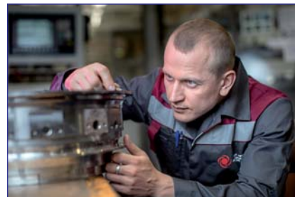
Оператор станков с ПУ выполняет контроль призонных отверстий
