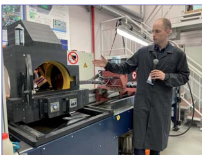
Магнитопорошковый дефектоскоп ЕрMag 1000 3D
