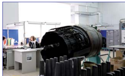
Участок дефектации горячей части АД
